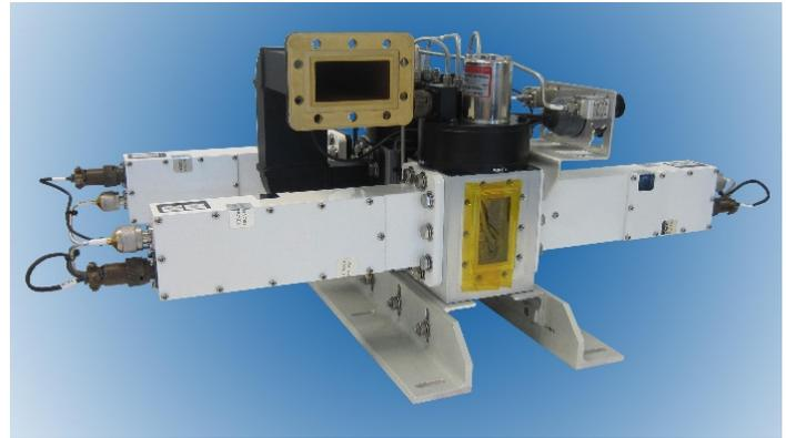
*Typical C-Band 1:2 LNA Plate Assembly*
